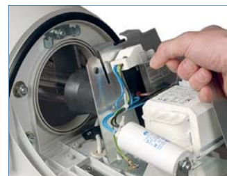
Panel elektroniky v podobě vyjímatelného předřadníku umístěný v předřadnickové části.
