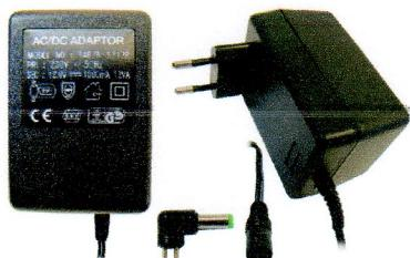
**POZOR** – ujistěte se, že připravený napáječ má skutečně stejnosměrný výstup! Pro Led nelze použít většinu transformátorů a spínaných zdrojů určených k napájení halogenových žárovek! I když se LED po připojení na nevhodný zdroj nemusí hned zničit, může k jejich zničení dojít po krátkém čase, nebo může dojít ke zničení zdroje.
